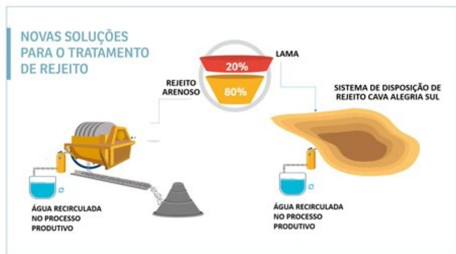
Com o processo de filtragem, a Samarco poderá filtrar a parte arenosa do rejeito (80% do total em volume) e empilhá-la de forma segura. Os 20% restantes serão depositados na cava Alegria Sul, uma estrutura rochosa confinada, o que aumenta a segurança. As obras de preparação da cava Alegria Sul começaram em outubro de 2018 e foram concluídas em meados deste mês.
