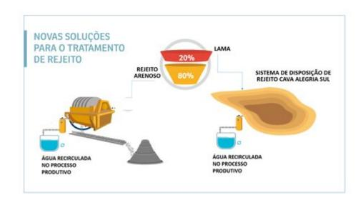
Com o processo de filtragem, a Samarco poderá filtrar a parte arenosa do rejeito (80% do total em volume) e empilhá-la de forma segura. Os 20% restantes serão depositados na cava Alegria Sul, uma estrutura rochosa confinada, o que aumenta a segurança. As obras de preparação da cava Alegria Sul começaram em outubro de 2018 e foram concluídas em meados deste mês.
